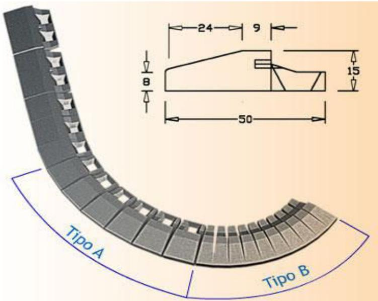
**Per curve con raggio da ml. 1,80 pezzi occorrenti tipo "A" (pezzi da cm. 32 per curva):**
